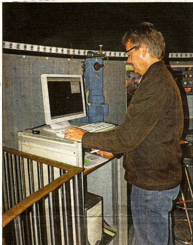
An diesem Computer laufen alle Mechanismen zusammen: Mit wenigen Mausklicks werden Kuppel und Teleskop auf das Zielobjekt abgestimmt. Im Hintergrund ist das Barcode-System zu sehen, mit dem die Kuppel ausgerichtet wird. (Foto: Heindl)
